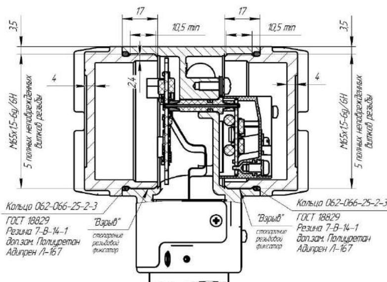
Рисунок Г.4 – Исполнение преобразователя с глухой крышкой
