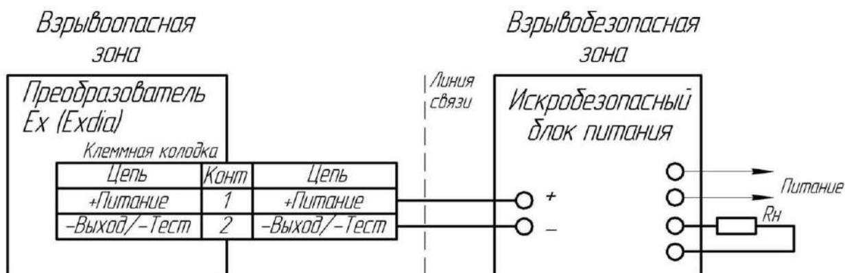
Рисунок В.6 — Схема электрических соединений преобразователей исполнений -Exdia и -Ex
