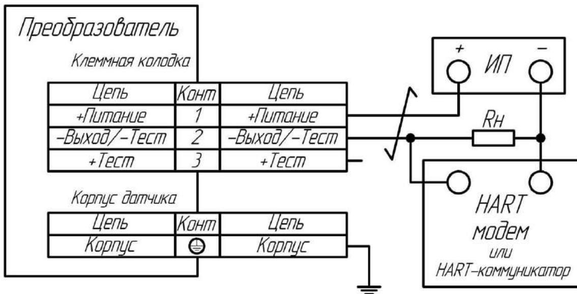
Рисунок В.4 — Схема подключения HART® модема к преобразователям
