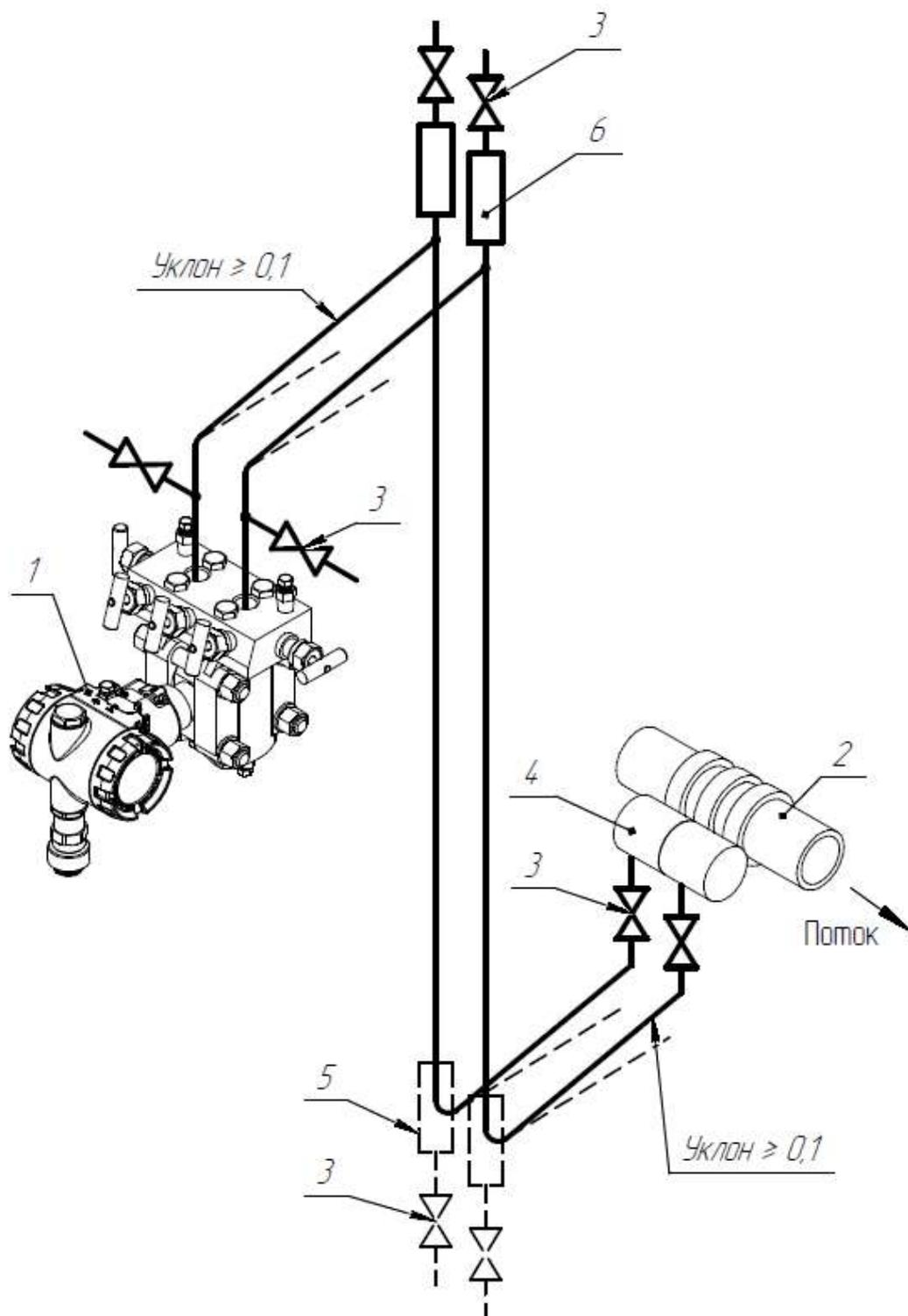
Рисунок Д.2.5 – Подключение СДВ-SMART для измерения расхода пара выше сужающего устройства:
