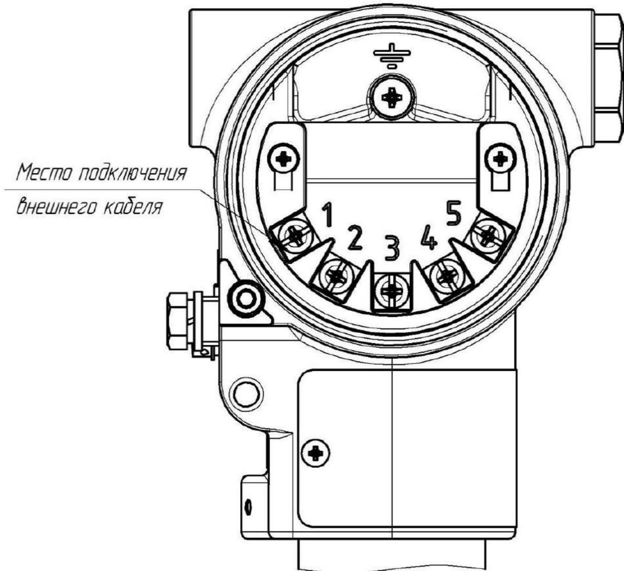
**Рисунок В.1 – Клеммная колодка преобразователей с конструктивным исполнением S, Op-S, Астр-S, M-S, НП-S по таблице А.5**
