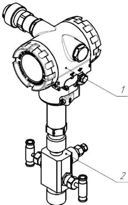
Рисунок Д.1.1 – СДВ-SMART (штуцерное исполнение) (1);
