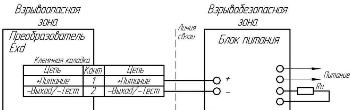
Рисунок В.5 — Схема электрических соединений преобразователей исполнений -Exd
