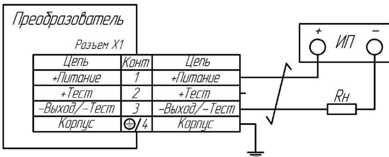
Рисунок В.3 – Схема подключения преобразователей с выходным разъемом
