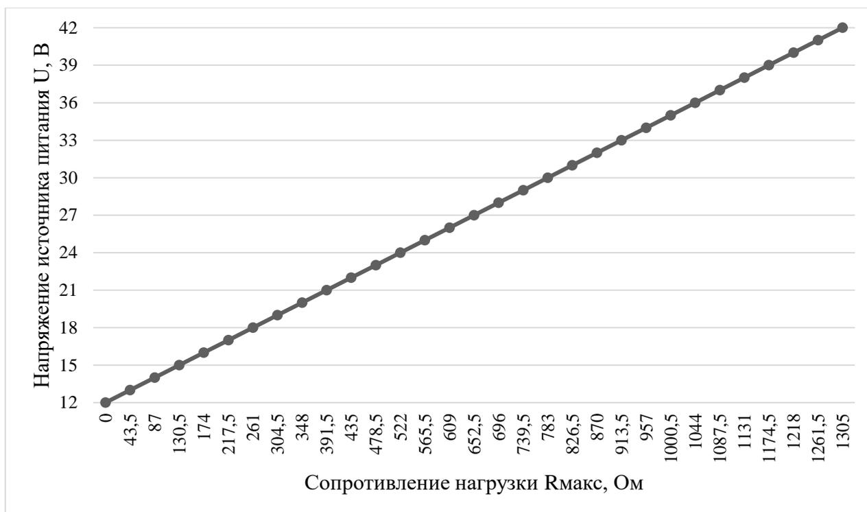
Рисунок 1 — Зависимость сопротивления нагрузки (включая сопротивление линии связи) от напряжения источника питания
