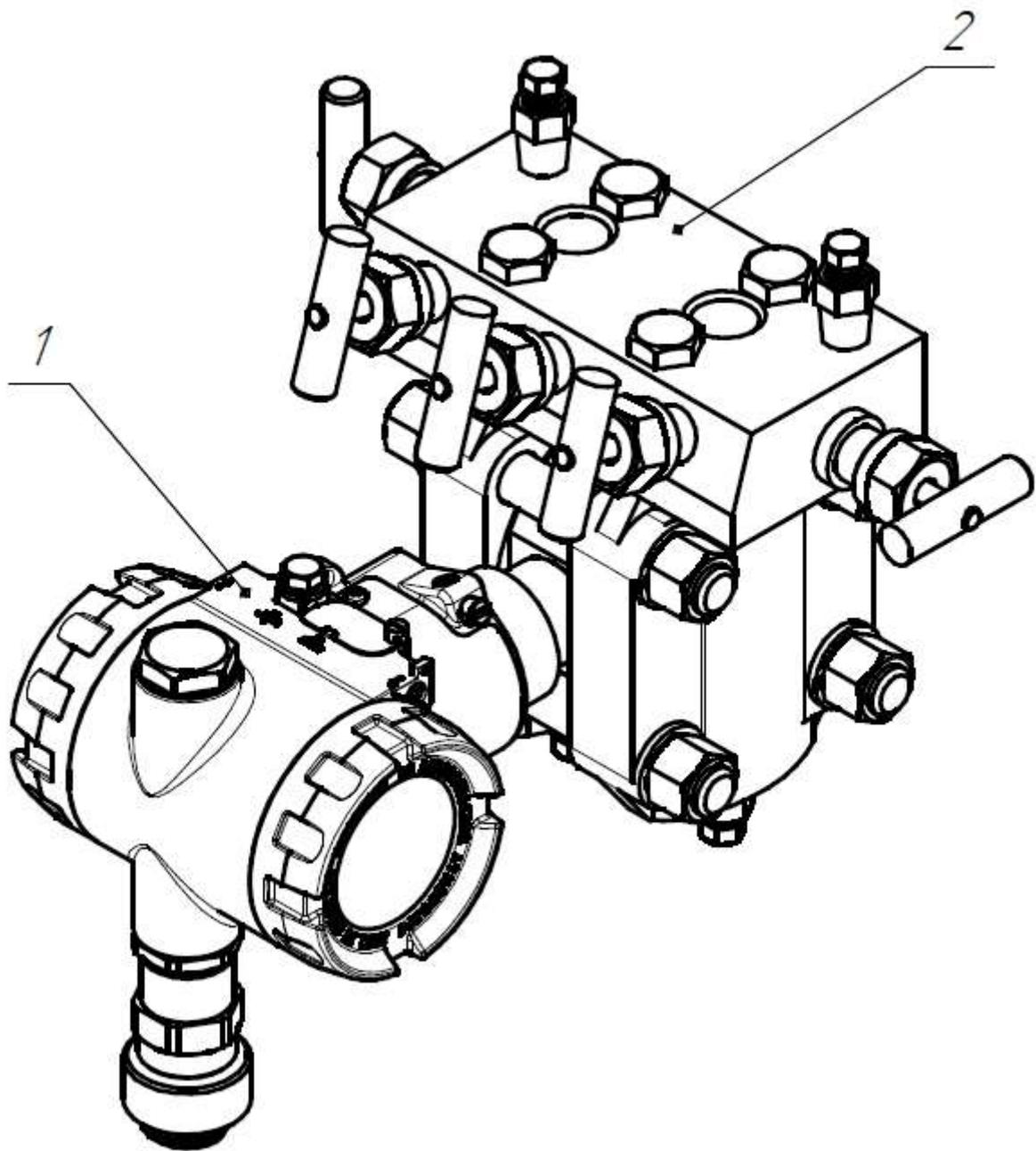
Рисунок Д.2.1 – СДВ-SMART (фланцевое исполнение) (1);
