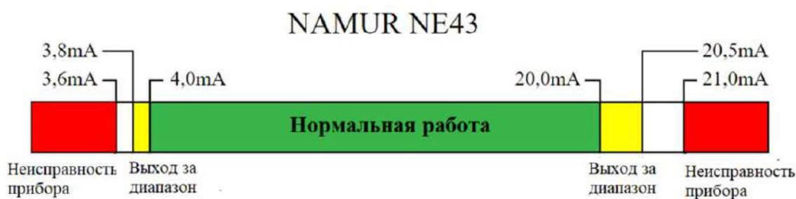
Рисунок 2 – Диаграмма токового сигнала преобразователя по стандарту NAMUR NE 43
